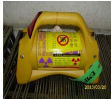
放射線照相檢驗設備
